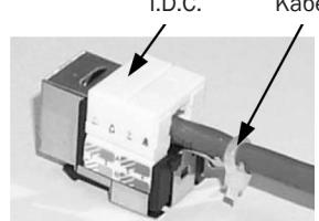
Наденьте кабельный хомут для уплотнения оболочки кабеля. Вставьте крышку коннектора с врезными контактами, чтобы зафиксировать эти провода.
