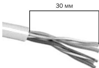
Снимите приблизительно 30 мм оболочки кабеля и разделите провода на 4 пары.
