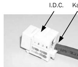
Вставьте крышку коннектора с врезными контактами, чтобы зафиксировать эти провода. Наденьте кабельный хомут для уплотнения оболочки кабеля и завершения установки.
