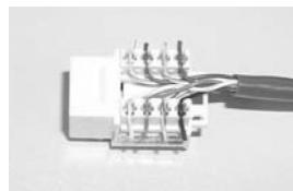
Следуйте наклейке с цветной маркировкой для подсоединения проводов T568A или T568B, отделите немного места в нужном местоположении и вставьте проводную пару попарно в каждый паз.
